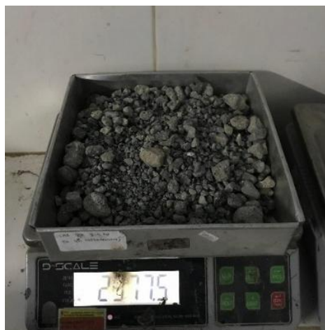
Gambar 4.1 Pengujian Keausan Agregat Alam dengan Mesin LAA
