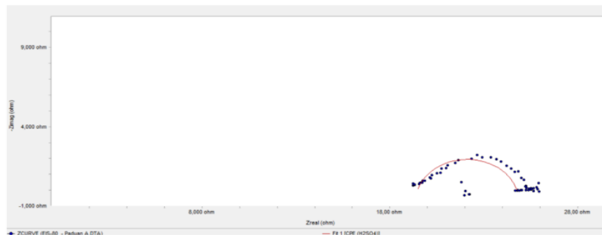
Gambar B.33 Kurva Nyquist Sampel 80.A pada Larutan \text{H}_2\text{SO}_4 .
