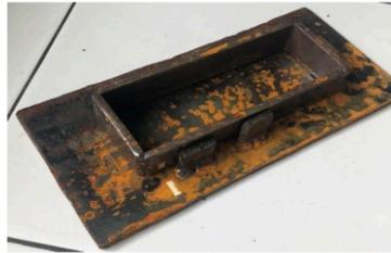
Gambar 3.3 Cetakan Papan Partikel
