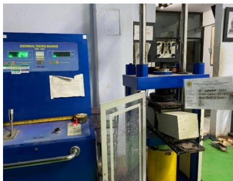
Gambar 5. 14 Pengujian Kuat Lentur Beton Balok (Sumber : Analisa Penulis, 2024)
