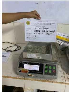
Gambar 5. 8 Pengujian Kadar Air Agregat Halus (Sumber : Analisa Penulis, 2024)
