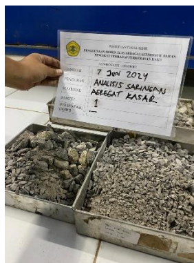
Gambar 5. 4 Pengujian Analisa Saringan Agregat Kasar (Sumber : Analisa Penulis, 2024)
