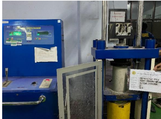
Gambar 5. 12 Pengujian Kuat Tekan Beton Silinder (Sumber : Analisa Penulis, 2024)
