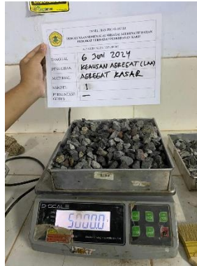
Gambar 5. 3 Pengujian LAA Agregat Kasar (Sumber : Analisa Penulis, 2024)
