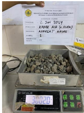
Gambar 5. 2 Pengujian Kadar Air Agregat Kasar (Sumber : Analisa Penulis, 2024)
