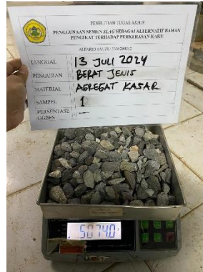
Gambar 5. 1 Pengujian Berat Jenis Agregat Kasar (Sumber : Analisa Penulis, 2024)
