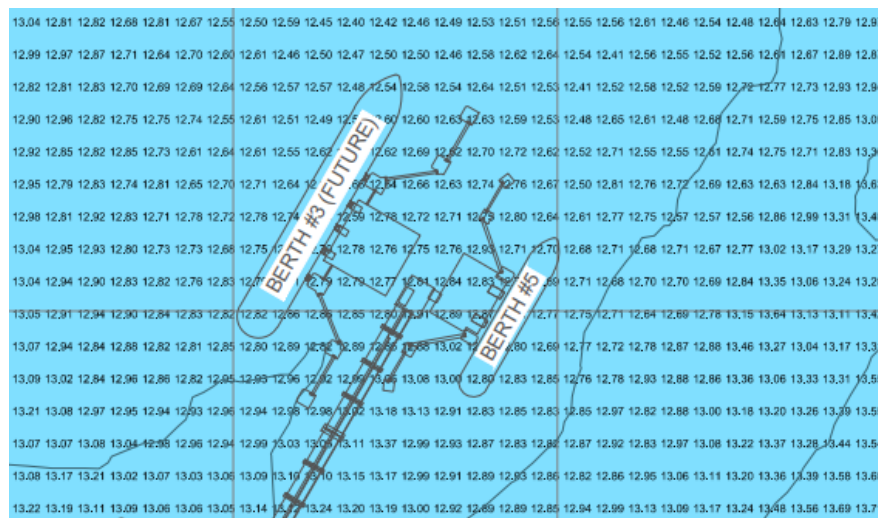
Gambar 5.1 Peta Batimetri Pembangunan Dermaga Jetty PT. XYZ
