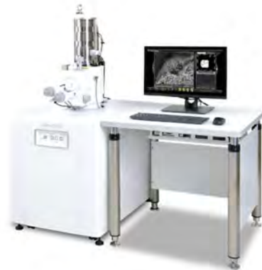
Gambar C.10 Alat Pengujian FESEM (Jeol JSM IT-200)
