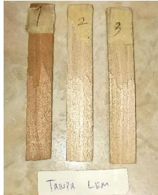
**Gambar 3.15** Sampel laminasi kayu mahoni tanpa lem setelah pengujian lentur
