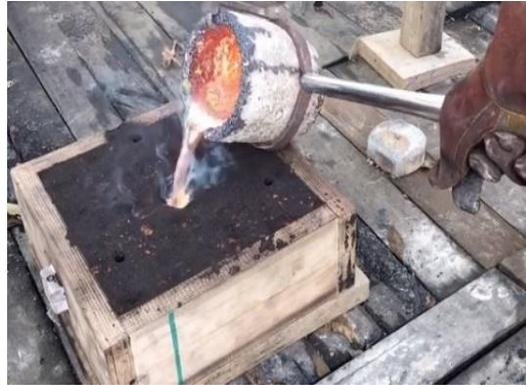
**Gambar 2.1** Pengecoran Logam
