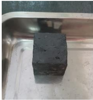
Gambar 3.4 Proses Pengeringan di udara Terbuka
