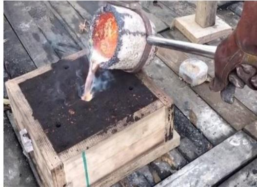
**Gambar 2.1** Pengecoran Logam
