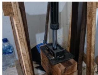
Gambar 3.15 proses penekanan kompaksi terhadap kayu
