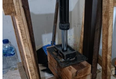
Gambar 3.16 proses penekanan kompaksi terhadap kayu
