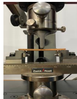
Gambar 3.10 Alat uji lentur
