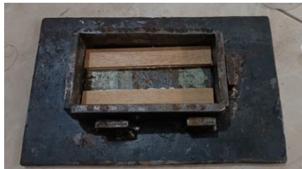
Gambar 3.15 peletakan kayu mahoni terhadap media kompaksi
