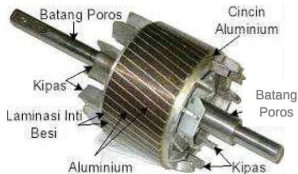
Gambar 2.3 Rotor sangkar pada motor induksi [17].
