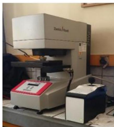
Gambar C.11 Mesin Uji Kekerasan
