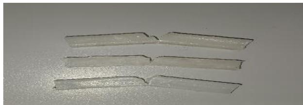
**Gambar 4. 25** Spesimen Uji Impact Material Kombinasi PP dan PET 200°C
