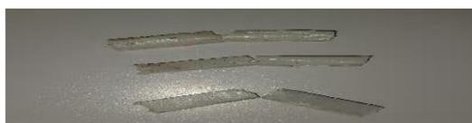
**Gambar 4. 22** Spesimen pengujian impak PET Murni
