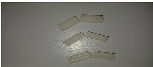
**Gambar 4. 28** Spesimen Uji Impak pada Material PP dan PET 250°C.
