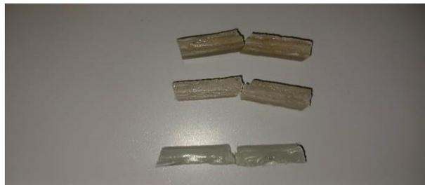
**Gambar 4. 19** Spesimen Uji Impak PP Murni
