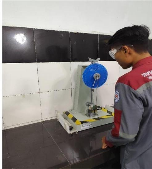
**Gambar 3. 4** Mesin *Impact Testing*
