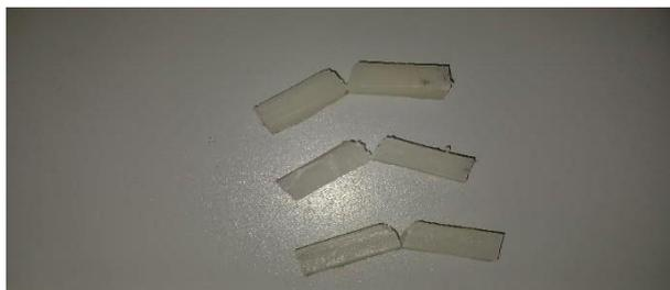
**Gambar 4. 28** Spesimen Uji Impact pada Material PP dan PET 250°C.
