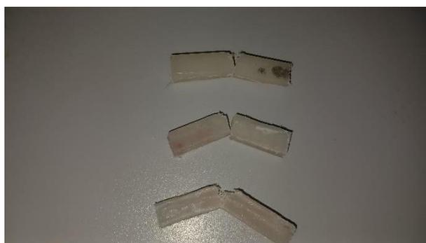
**Gambar 4. 31** Spesimen Uji Impak Material
