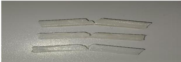
**Gambar 4. 25** Spesimen Uji Impak Material Kombinasi PP dan PET 200°C
