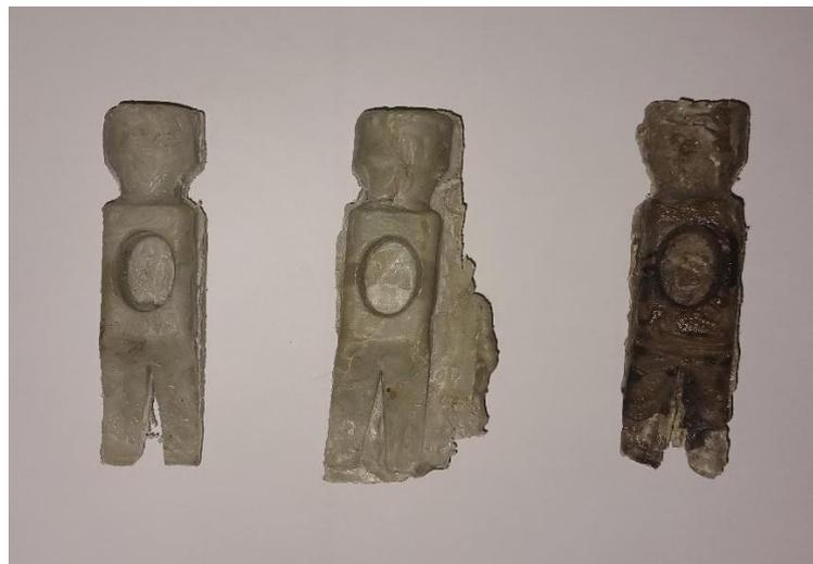
**Gambar 4. 1** Hasil Produk Palu *Injection Moulding*
