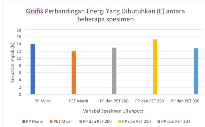
**Gambar 4.37** Grafik Perbandingan Energi Yang Dibutuhkan (E) pada setiap spesimen uji
