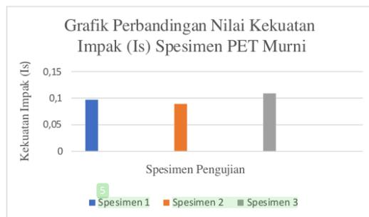
**Gambar 4.20** Grafik Perbandingan Kekuatan Impak (Is) untuk Spesimen PET Murni
