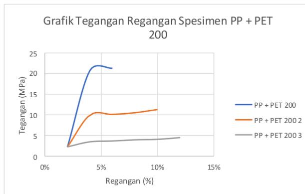
**D. Gambar Grafik Tegangan Regangan Pengujian Tarik Plastik Polypropylen (PP)**
