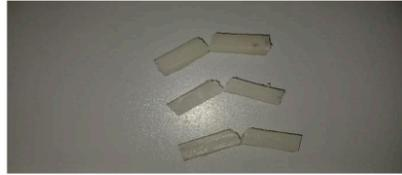
**Gambar 4. 28** Spesimen Uji Impak pada Material PP dan PET 250°C.
