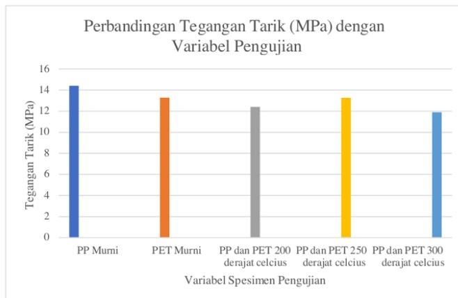
**Gambar 4. 33** Kurva Perbandingan Tegangan Tarik
