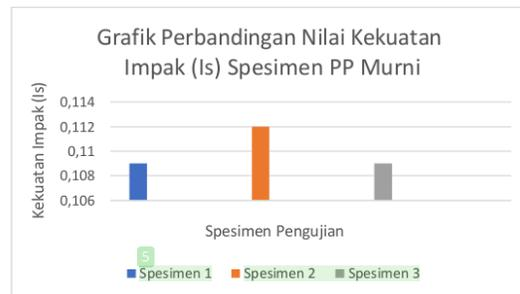
**Gambar 4. 17** Grafik Perbandingan Nilai Kekuatan Impact Spesimen PP Murni
