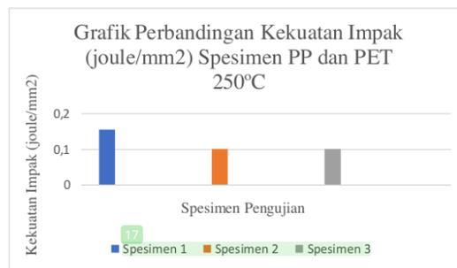
**Gambar 4. 26** Grafik Perbandingan Nilai Kkeuatan Impact pada Spesimen PP dan PET 250°C
