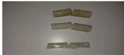
**Gambar 4. 19** Spesimen Uji Impak PP Murni
