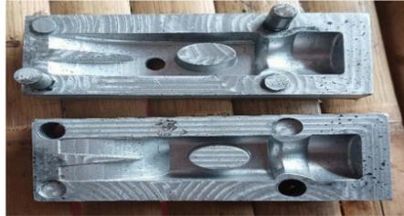
**Gambar 3. 5** *Mold* (Cetakan)
