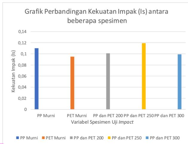
**Gambar 4. 36** Grafik Perbandingan Kekuatan Impact (Is) pada setiap spesimen uji
