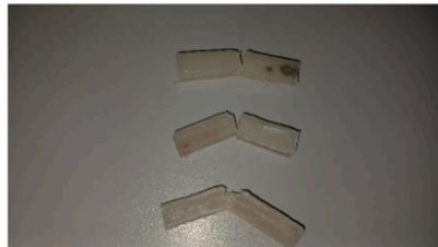
**Gambar 4. 31** Spesimen Uji Impak Material
