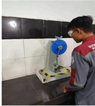
**Gambar 3. 4** Mesin *Impact Testing*
