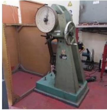
**Gambar 3.12** Alat Uji Impak
