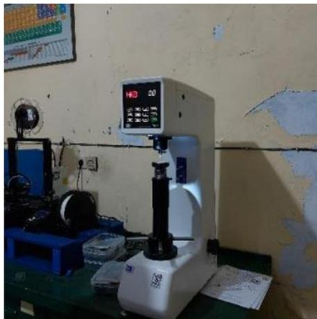
**Gambar 3.11** Alat Uji Kekerasan
