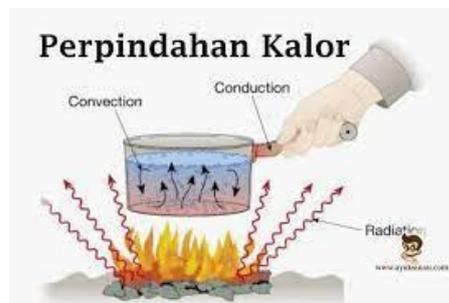
**Gambar 2.6** Ilustrasi Perpindahan Panas
