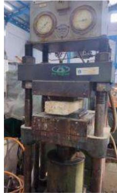
**Gambar 3.4** Mesin *Coldpress*
