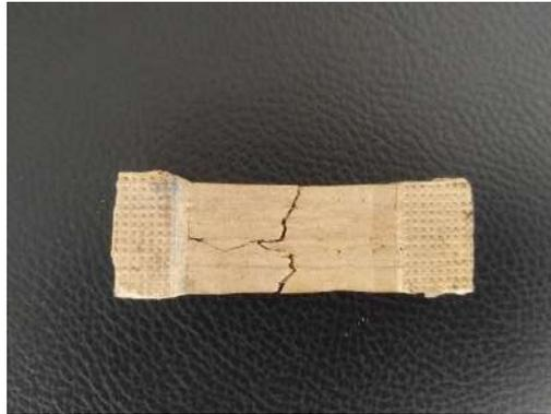
**Gambar 3.21** Spesimen Uji Setelah Dilakukan Uji Tarik
