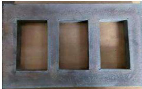
**Gambar 3.5** Cetakan Papan Partikel
