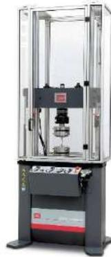
**Gambar 3.6** Mesin UTM MTS Landmark 100 kN
