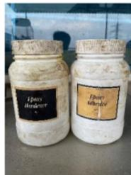
**Gambar 3.18** Resin Epoksi
