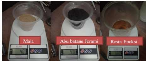
Gambar 3.34 Proses Penimbangan Bahan Material Kode C
