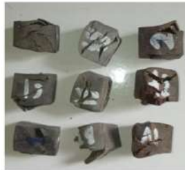
Gambar 4.1 Benda Uji Setelah Pengujian Tekan
