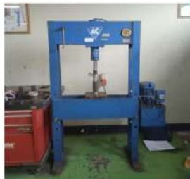
Gambar 3.8 Mesin Press Hidrolik
