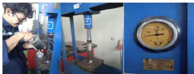
Gambar 3.37 Proses Kompaksi Material Komposit
