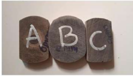
Gambar 4.6 Benda Uji Setelah Pengujian Kekerasan
