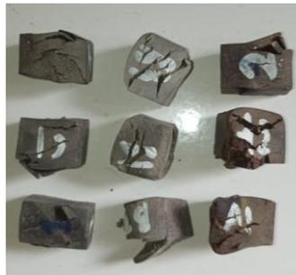
**Gambar 4.1** Benda Uji Setelah Pengujian Tekan
