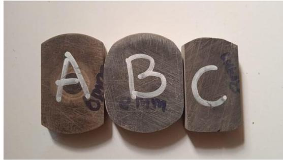
**Gambar 4.6**Benda Uji Setelah Pengujian Kekerasan
