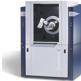
**Gambar 3.4**Alat Uji XRD
