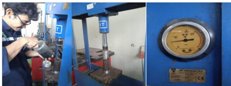
**Gambar 3.37**Proses Kompaksi Material Komposit
