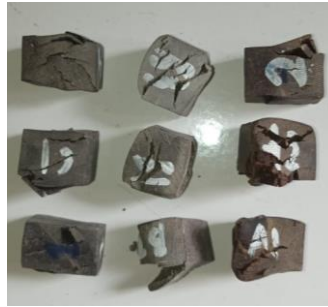
Gambar 4.1 Benda Uji Setelah Pengujian Tekan
