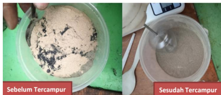
Gambar 3.35 Proses Pencampuran Serbuk Kulit Maja Dan Abu Jerami
