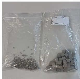
Gambar C.27 Sampel Ti Murni
