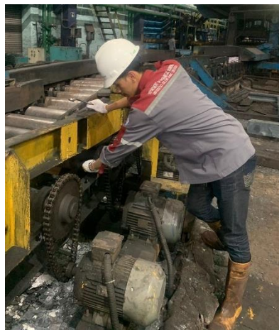
Gambar 4.18 Pengecekan Kondisi Pondasi Roll Table Interface (Sumber : PT Krakatau Baja Konstruksi)
