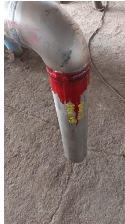
Gambar 4.2 benda kerja setelah diberi penetrant
