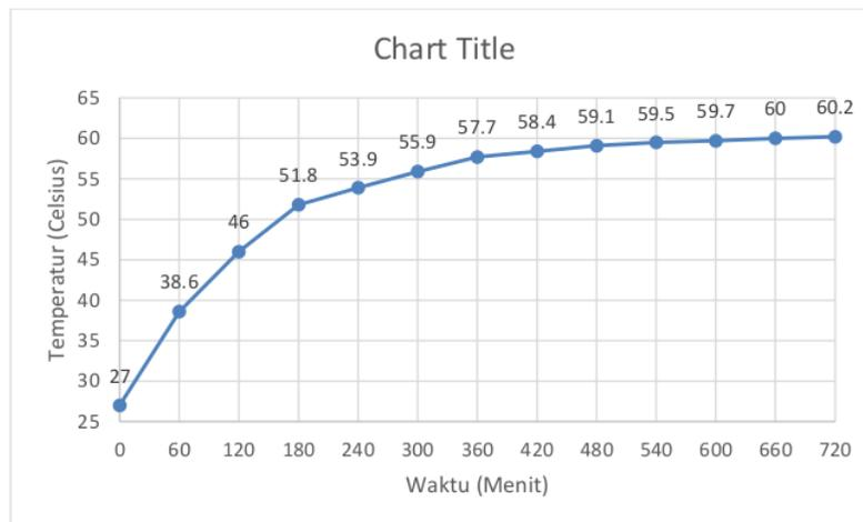
**Gambar 4.2** Grafik Kenaikan Suhu Mekanisme 1
