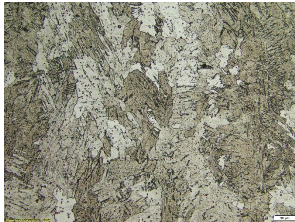
Gambar 4.11 Gambar Hasil Pengujian Metalografi Pada Elektroda Lokal 190 Ampere (a) Daerah BM (b) Daerah HAZ (c) Daerah WM
