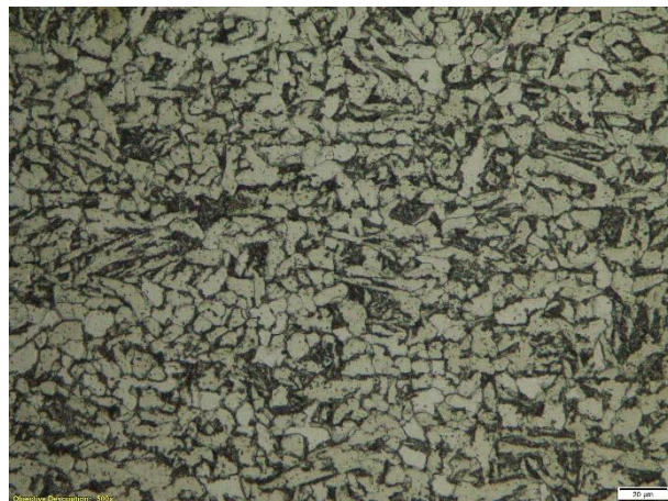
Gambar 4.10 Gambar Hasil Pengujian Metalografi Pada Elektroda Lokal 155 Ampere (a) Daerah BM (b) Daerah HAZ (c) Daerah WM
