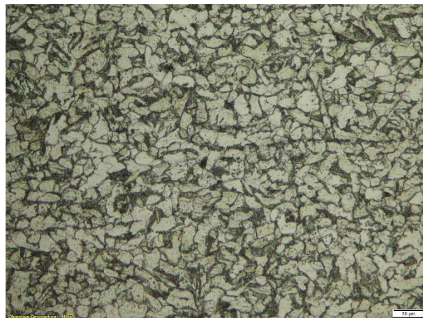
Gambar 4.9 Gambar Hasil Pengujian Metalografi Pada Elektroda Lokal 120 Ampere (a) Daerah BM (b) Daerah HAZ (c) Daerah WM
