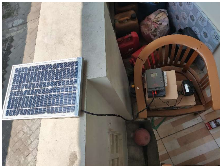
Gambar 4.13 Monitoring Pengisian Aki dengan Panel Surya
