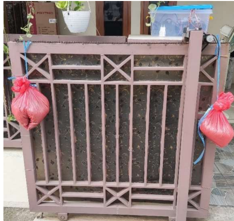
Gambar 4.12 Penambahan Beban Pada Pagar
