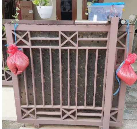
Gambar 4.12 Penambahan Beban Pada Pagar
