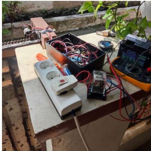
Gambar 4.9 Rangkaian Daya Cadangan
