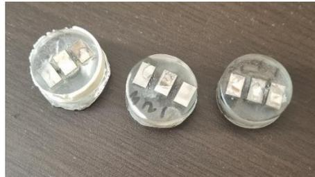
**Gambar 3.7** Sampel Inconel 718 Setelah *Etching*
