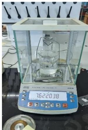
**Gambar 3.9** Alat Uji Densitas
