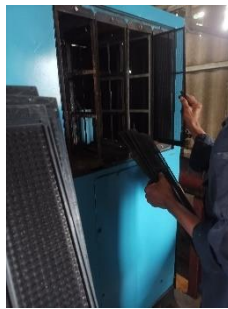
Gambar 4. 4 Proses melepaskan filter dari kompresor
