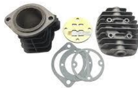
Gambar 3. 1 Silinder dan kepala silinder
