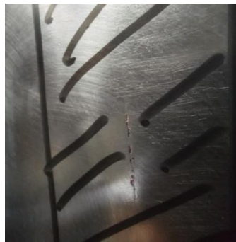
Gambar 4.2 Longseam 1 (Indikasi Relevan Berbentuk Linier)
