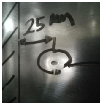
Gambar 4.3 Longseam 1 (Indikasi Relevan Berbentuk Rounded )
