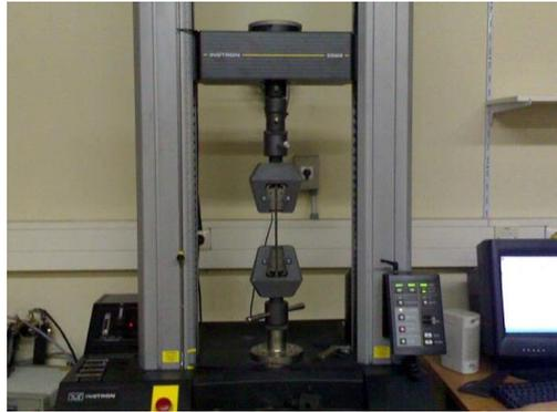
**Gambar 3.13** Mesin Uji Tarik
