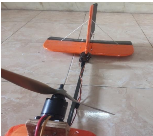
Servo Rudder ke Kiri
