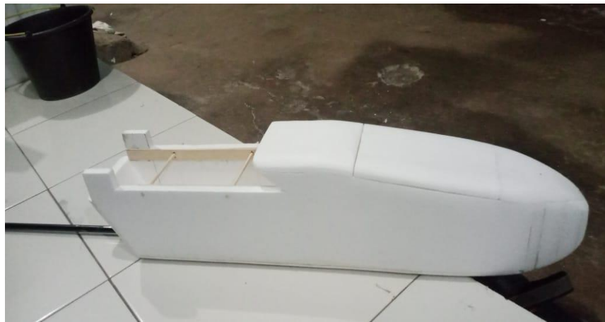
Gambar 4.1 Pembuatan Bodi Pesawat ( Fuselage ).
