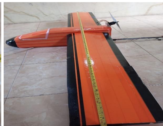
Panjang Wingspan 200cm
