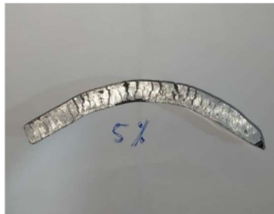
Gambar 4.3 Sampel Komposit yang Pecah Akibat Rolling
