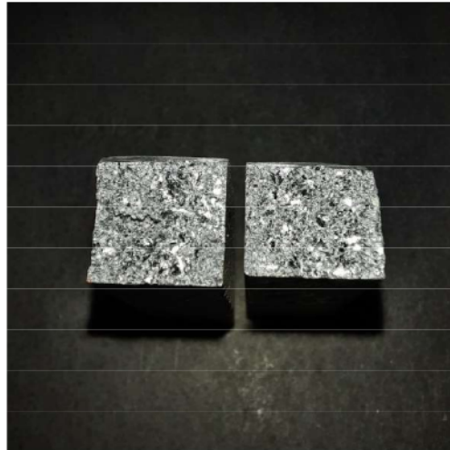
Gambar 4.6 Patahan Sampel dengan Reduksi Ketebalan 4%
