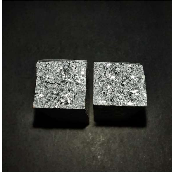
Gambar 4.6 Patahan Sampel dengan Reduksi Ketebalan 4%
