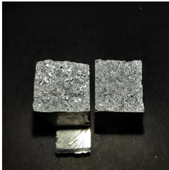
Gambar 4.5 Patahan Sampel dengan Reduksi Ketebalan 2%
