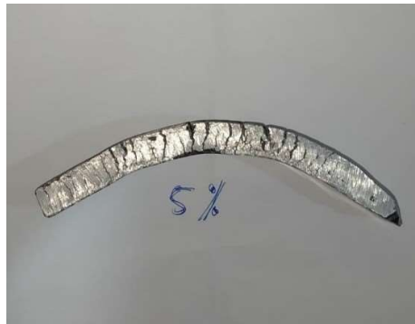
Gambar 4.3 Sampel Komposit yang Pecah Akibat Rolling
