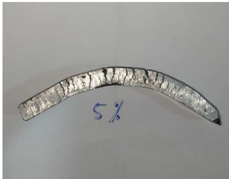
Gambar 4.3 Sampel Komposit yang Pecah Akibat Rolling
