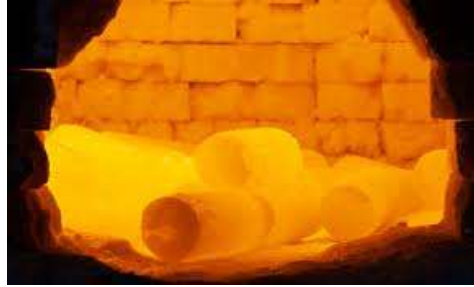
Gambar 2.5 Contoh Artificial Aging pada Logam
