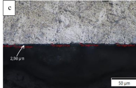
Gambar 4.13 Ketebalan lapisan oksida dengan temperatur 700 °C (a. siklus 6, b. siklus 8, dan c. siklus 10)
