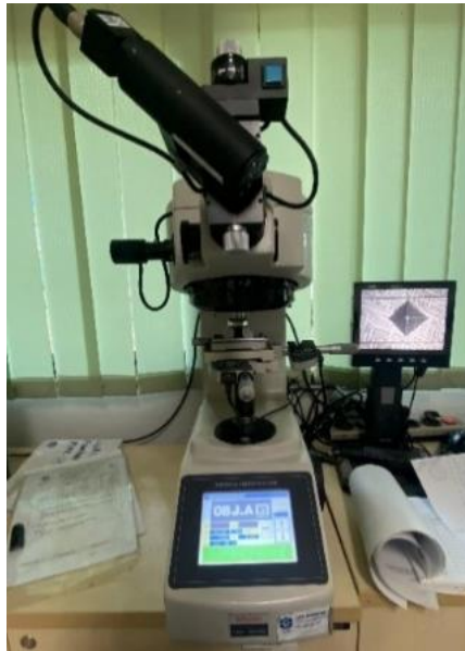
Gambar 3.5 Mesin uji kekerasan
