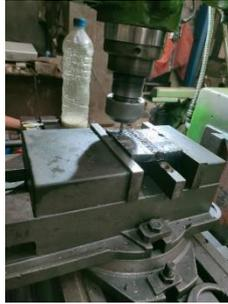
**Gambar 3.22** Proses pembentukan specimen laju korosi
