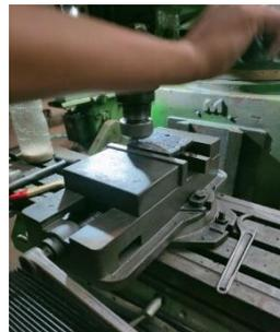
**Gambar 3.21** Pemotongan benda uji
