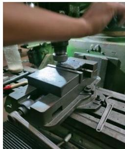
**Gambar 3.21** Pemotongan benda uji
