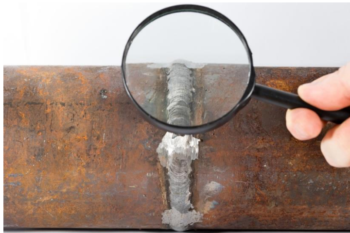
Gambar 3.5 Contoh Visual Inspection Dengan Lup
