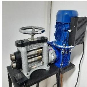
**Gambar 3.44** Mesin *Rolling*
