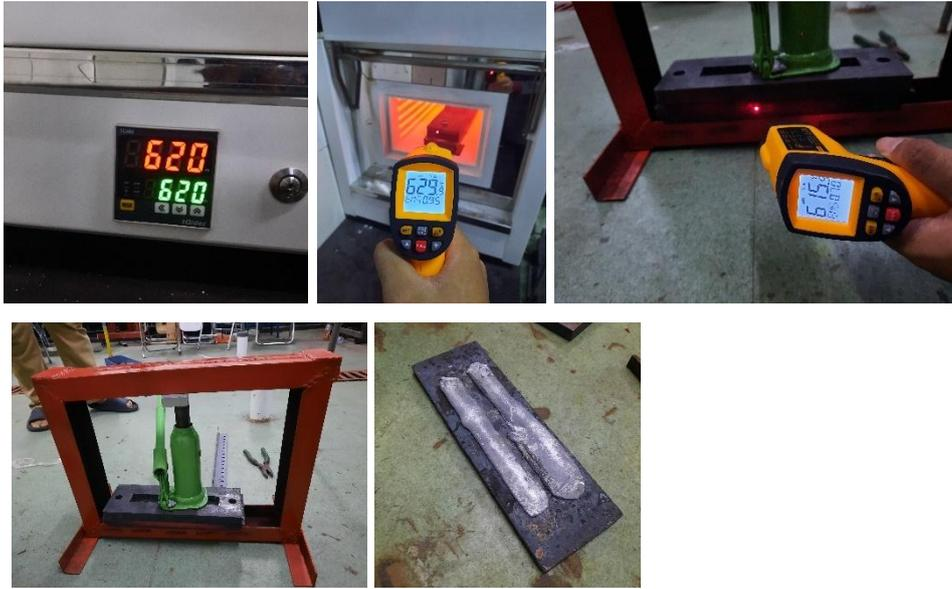
a) Pengukuran hasil thixoforming (Spesimen 1)
