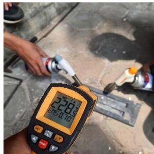
**Gambar 3.35** Proses pembersihan dan pemanasan cetakan
