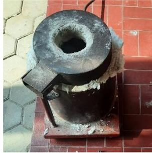
**Gambar 3.6** Tungku *Stir Casting*
