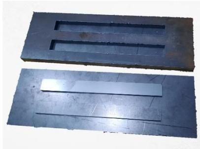
**Gambar 3.4** Cetakan Spesimen
