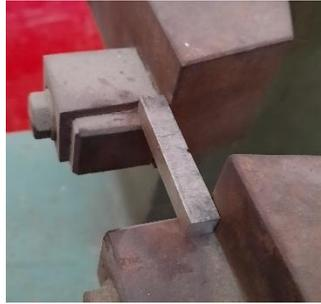
**Gambar 3.51** Peletakan spesimen pada Uji impak
