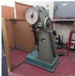
**Gambar 3.20** Alat Uji Impak
