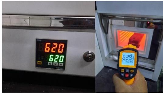
**Gambar 3.38** Suhu pada *furnace* (*thixoforming*)
