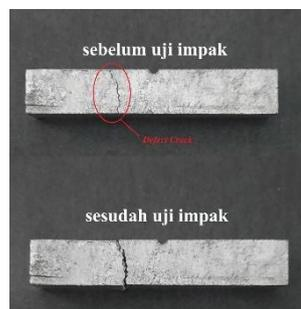
**Gambar 4.6** Defect pada spesimen uji impact
