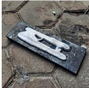
**Gambar 3.37** Hasil proses *stir casting*
