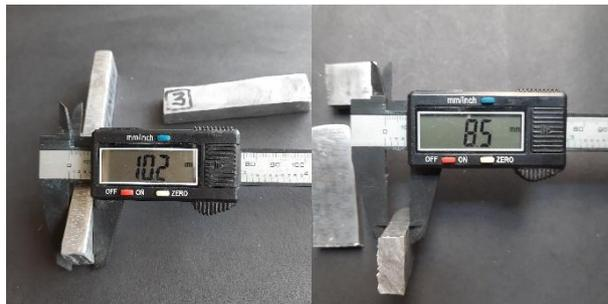
**Gambar 3.46** Pengukuran ketebalan sampel sebelum dan sesudah
