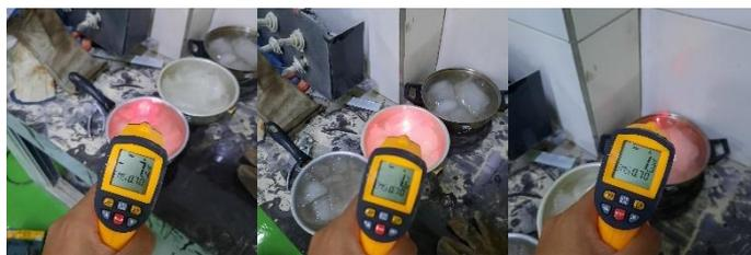
**Gambar 3.49** Suhu air untuk proses *quenching*
