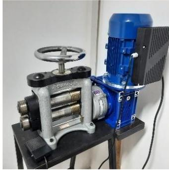
**Gambar 3.16** Mesin *Rolling*
