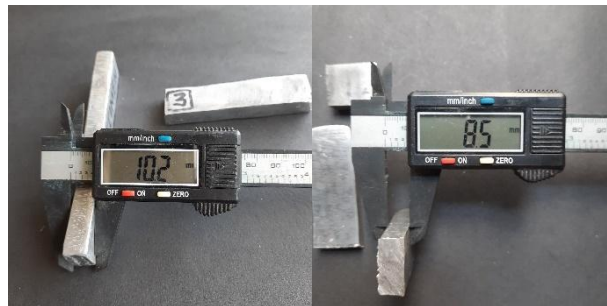
Gambar 3.46 Pengukuran ketebalan sampel sebelum dan sesudah
