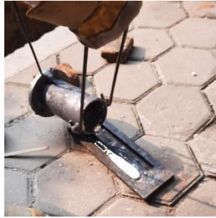
Gambar 3.36 Proses penuangan cetakan
