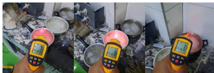
Gambar 3.49 Suhu air untuk proses quenching
