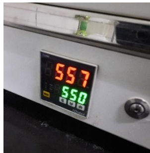
Gambar 3.48 Suhu pada furnace ( Solutioning )
