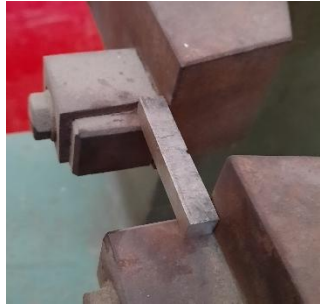
Gambar 3.51 Peletakan spesimen pada Uji impak
