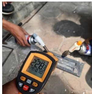
Gambar 3.35 Proses pembersihan dan pemanasan cetakan
