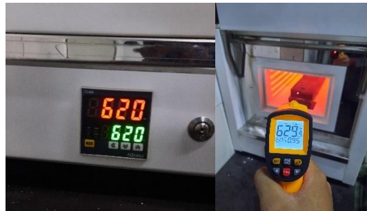
Gambar 3.38 Suhu pada furnace ( thixoforming )
