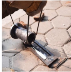
Gambar 3.36 Proses penuangan cetakan
