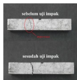
Gambar 4.6 Defect pada spesimen uji impak
